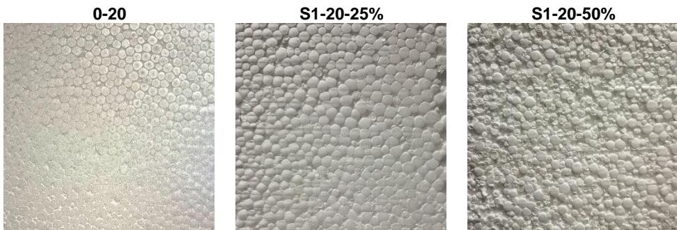
**Slika 7.** Prikaz strukture proizvedenog materijala (novi EPS lijevo, 25% reciklata sredina, 50% reciklata desno)
