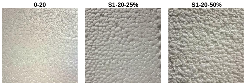
Slika 7. Prikaz strukture proizvedenog materijala (novi EPS lijevo, 25% reciklata sredina, 50% reciklata desno)
