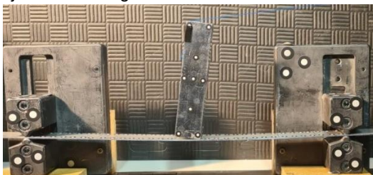
Slika 1. Model krutog bloka na elastičnoj gredi
