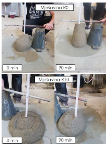
Slika 1. Ispitivanje betona u svježem stanju (konzistencija slijeganjem)
