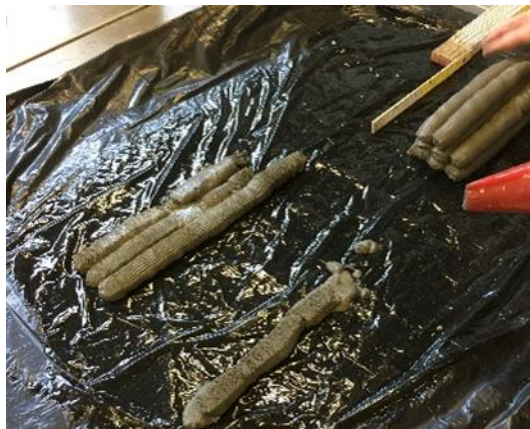
Slika 2. Istiskivanje morta i simuliranje uvjeta 3D printera
