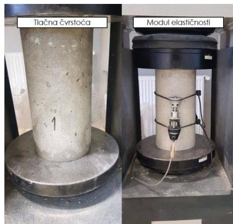
Slika 2. Ispitivanje betona u očvrslom stanju (tlačna čvrstoća i modul elastičnosti)
