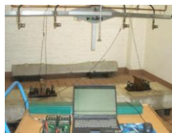
Slika 3. Oprema za prskanje s okvirom i instrumentima za napajanje/mjerenje
