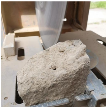
Slika 1. Rezanje uzoraka iz velikih komada nabijene zemlje
