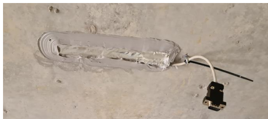
Slika 6. Postavljena mjerna traka za beton
