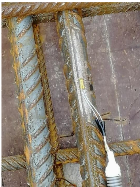
Slika 5. a) privremeno fiksirana mjerna traka za čelik, b) zaštićena mjerna traka
