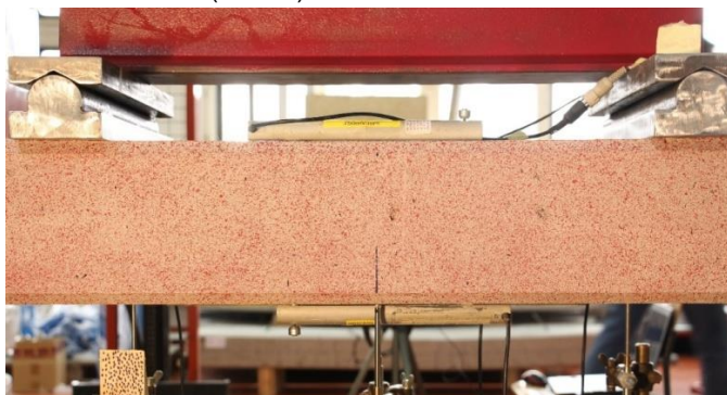
Slika 1. Površina uzorka pripremljena za digitalnu analizu slike
