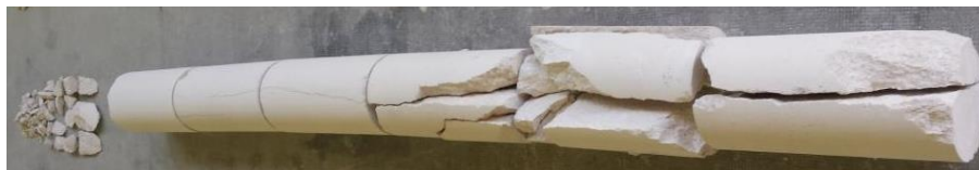
Slika 6 – Izgled nekog testiranog stupa nakon sloma pod centričnim tlakom
